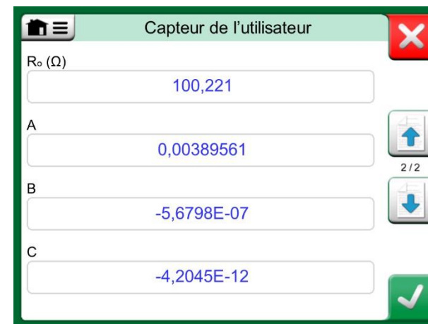
Exemple de page de configuration pour la constante Callendar van Dusen et les coefficients.
