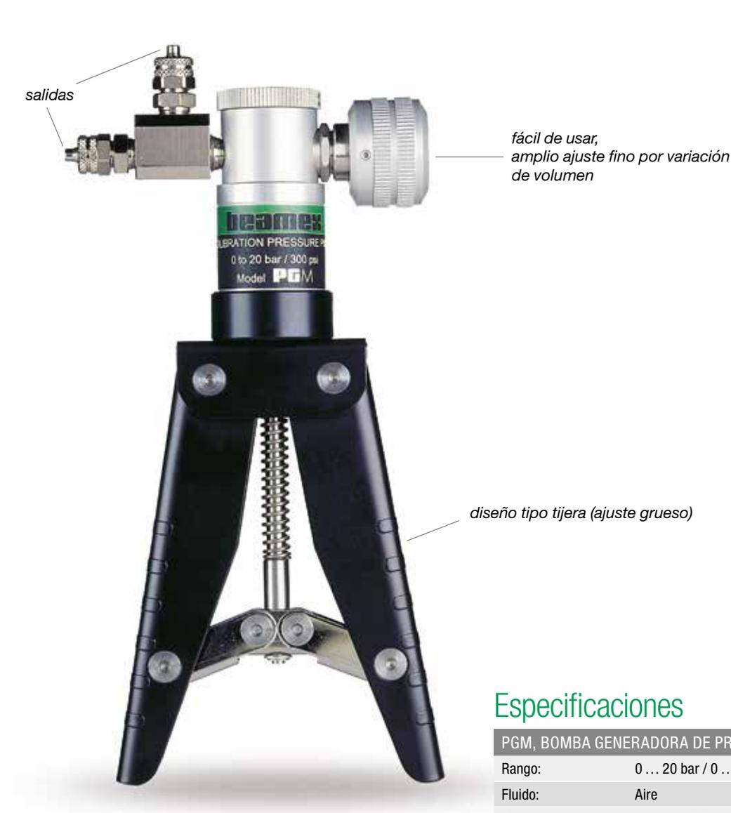
**La PGM** es una bomba manual de calibración que genera presión utilizando aire como fluido transmisor. Su control de volumen extremadamente preciso permite un excelente ajuste fino de la presión deseada. La robusta y exclusiva construcción de esta bomba la convierte en la mejor herramienta para la calibración en campo.
