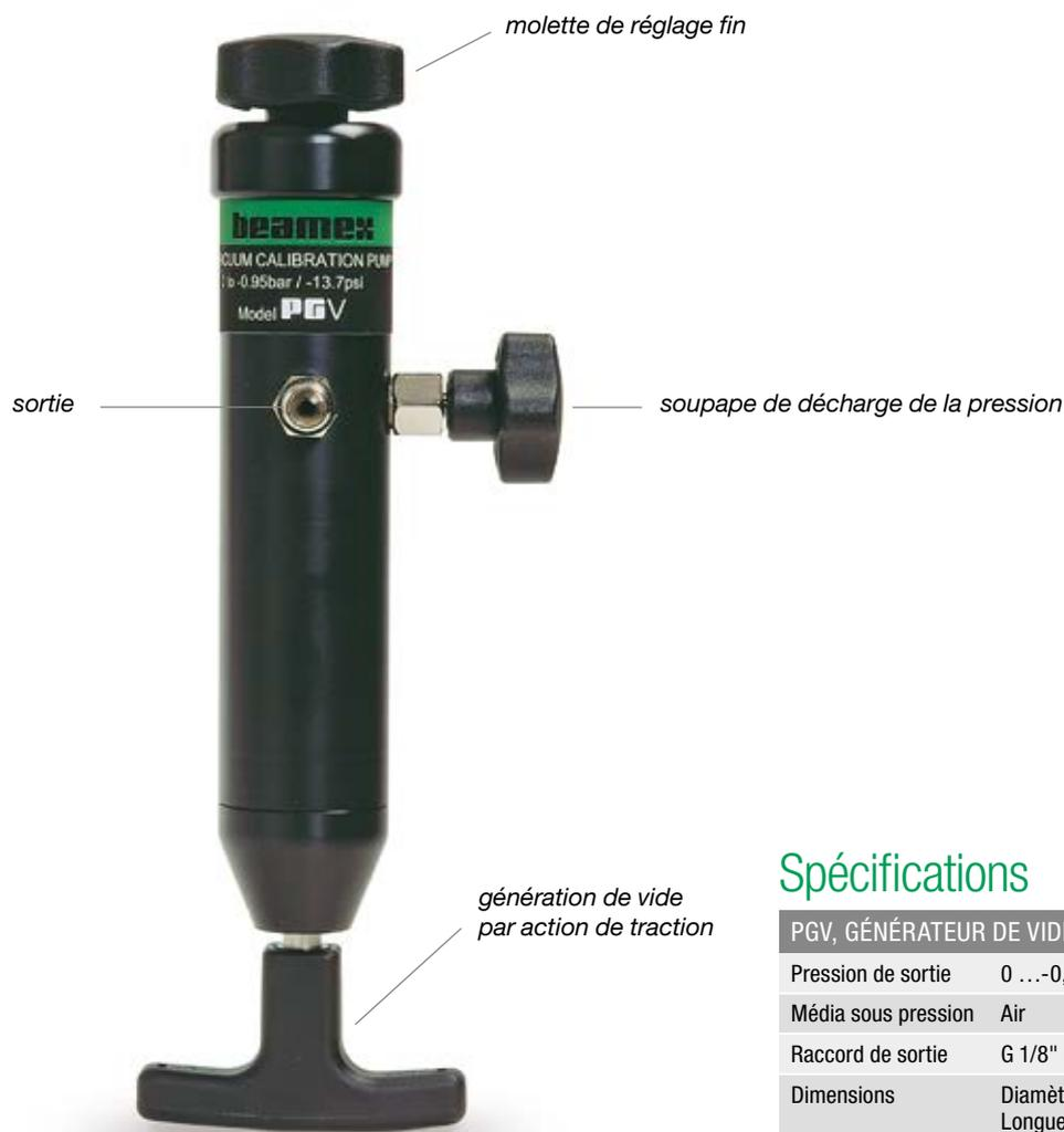
**Le PGV** est une pompe à vide très efficace qui génère un vide rapidement à l'aide d'une action de traction. Sa commande de volume sensible permet le réglage fin du vide généré. Sa construction compacte, robuste et légère est conçue pour être utilisée dans des environnements de terrain difficiles.
