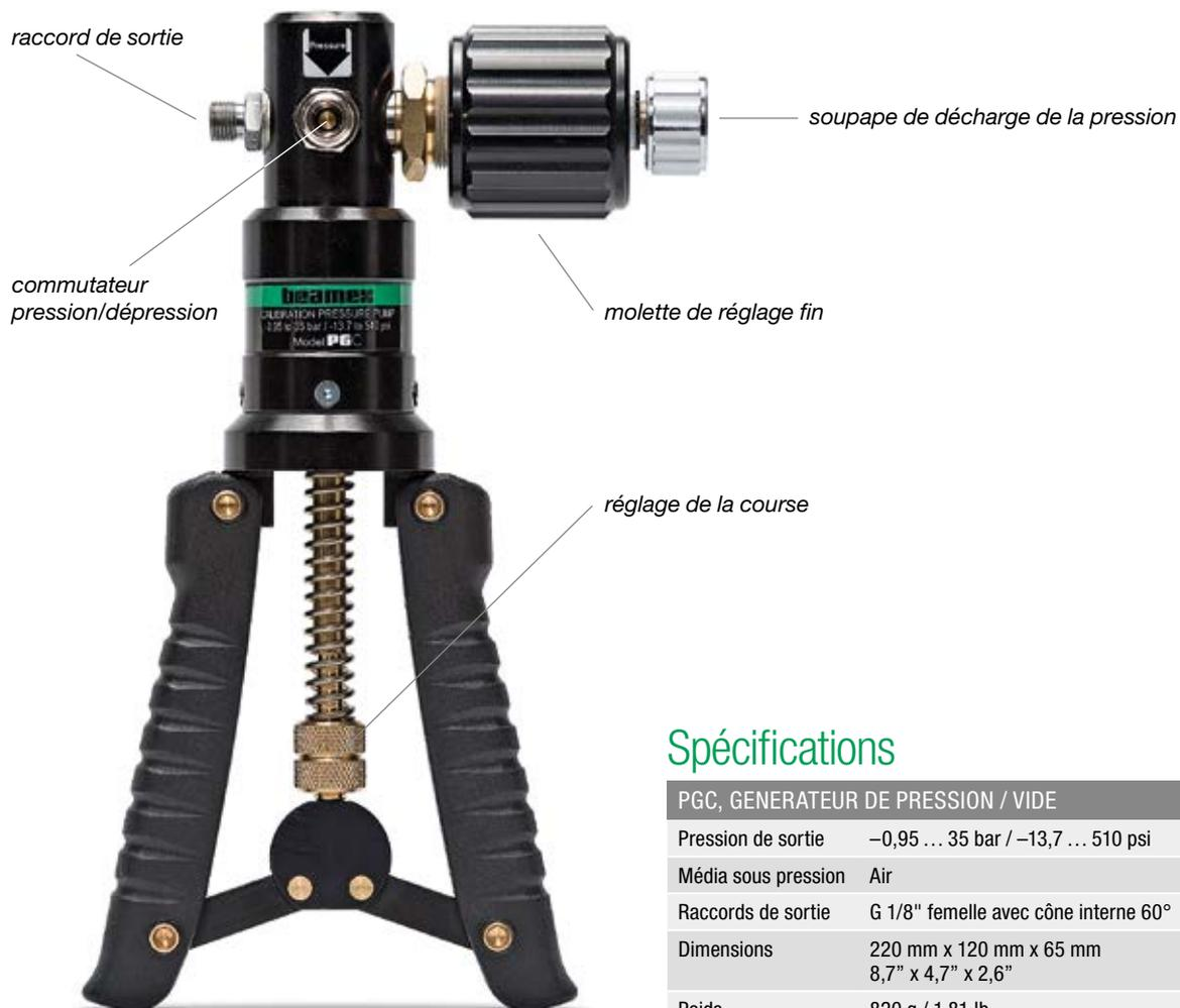
**La PGC** est une pompe à main pneumatique destinée à générer de la pression et du vide. Grâce au commutateur vous pouvez rapidement choisir entre génération de pression ou de vide. Le réglage fin permet d'ajuster précisément la pression générée.
