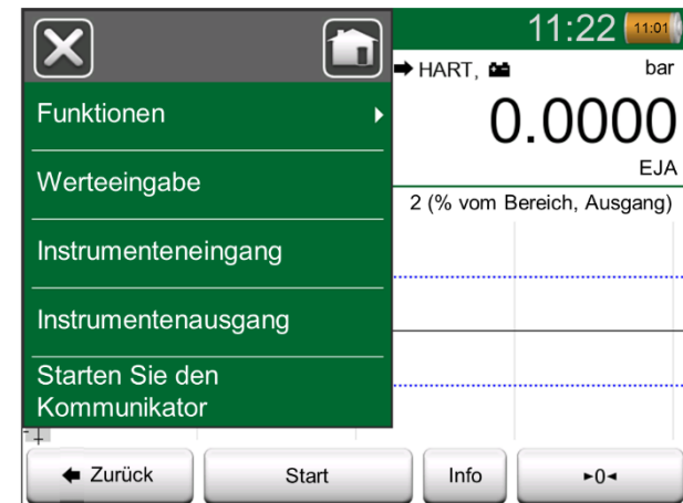
Bei Kalibrierung eines HART-Instruments im Dokumentierenden Kalibrator erscheinendes Menü
