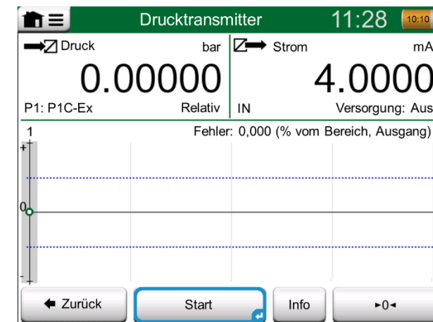
Taster in der unteren rechten Ecke zum Nullstellen eines Druckmoduls.
