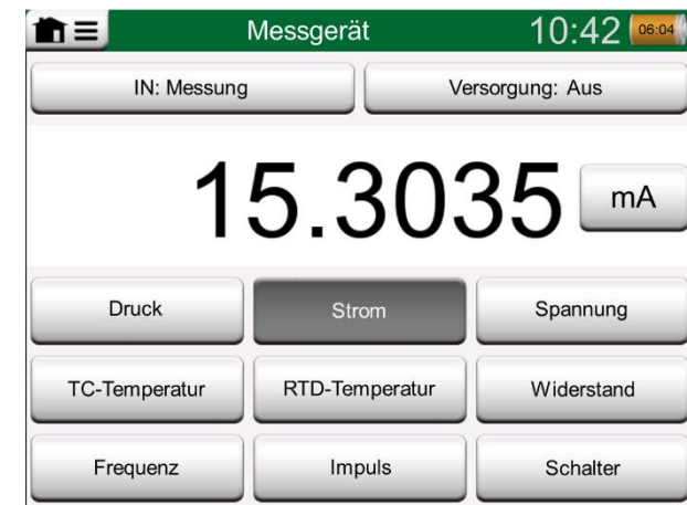
Strommessung mit dem Messgerät
