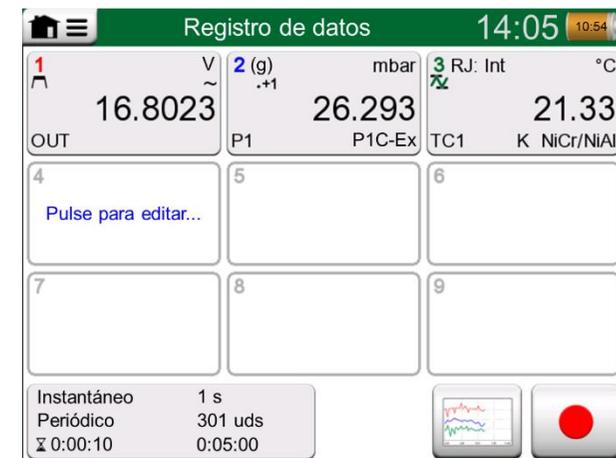
*Tres canales configurados en la ventana principal de configuración.*
