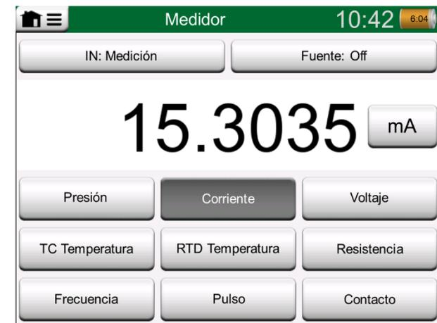
*Medición de corriente utilizando el Medidor*
