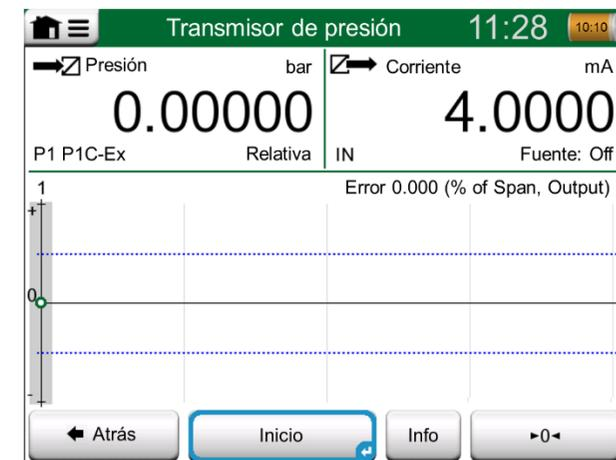
Botón para ajustar a cero un módulo de presión en la esquina inferior derecha.
