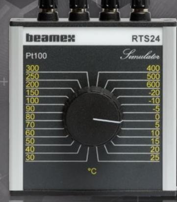
Hochpräzises Gerät zum Simulieren von Pt100 Widerstandsthermometern 85
