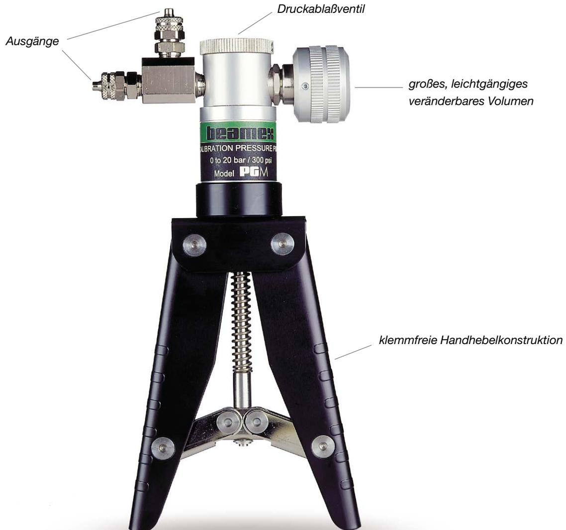
Die pneumatische Kalibrierhandpumpe **PGM** (alte Bezeichnung: PG300V) verwendet Luft als Druckmedium. Das integrierte, präzise arbeitende Variovolumen ermöglicht eine extrem genaue Druckvorgabe. Die robuste und ökonomische Konstruktion machen die Handpumpe zum idealen Werkzeug für die Druckvorgabe vor Ort.
