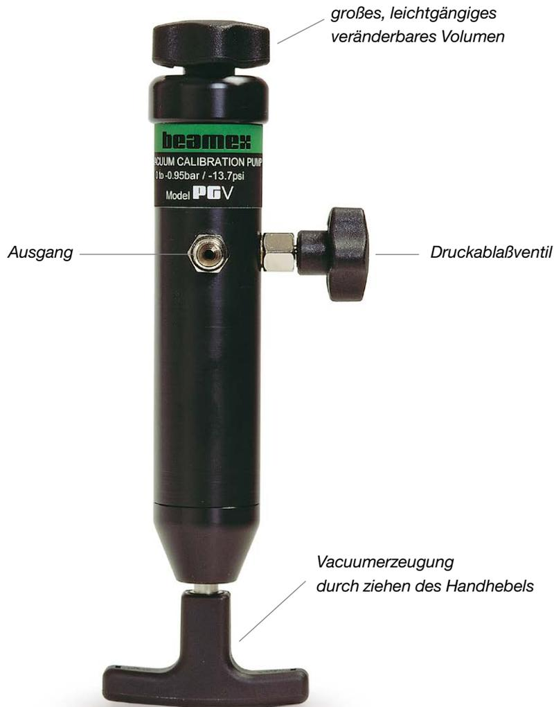
Die **PGV** ist eine neu entwickelte, effiziente Vakuumpumpe. Über ein variables Volumen läßt sich der erzeugte Unterdruck sehr präzise feineinstellen. Die PGV ist kompakt, leichtgewichtig und besonders robust konstruiert und eignet sich somit hervorragend für den Feldeinsatz.
