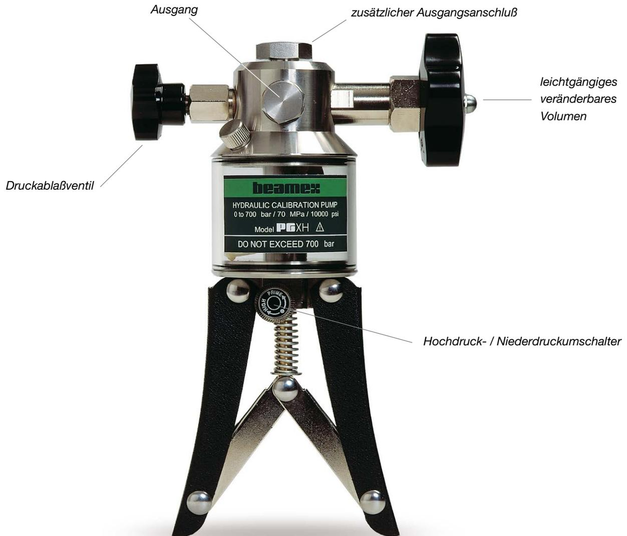
Die hydraulische Kalibrierhandpumpe **PGXH** ist für verschiedene Flüssigkeiten geeignet. (z.B. Mineralöl, destilliertes Wasser, etc.) Optional ist eine Skydrol-Ausführung für aggressive Medien (z.B. Bremsflüssigkeit) lieferbar. Das präzise, einstellbare Variovolumen ermöglicht eine exakte Feineinstellung des generierten Druckes. Zusätzlich steht eine Reihe von einstellbaren Überdruckventilen zur Verfügung.
