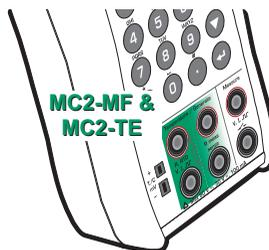
I due terminali più a sinistra sono usati in sistemi a 2 fili. L'MC2 verifica automaticamente la connessione e visualizza il sistema di fili riscontrato (a 2 fili, a 3 fili o a 4 fili) nell'angolo in alto a destra della finestra di misurazione. Per ulteriori informazioni sulle opzioni riguardanti i fili, consultare il capitolo **Misurazione di resistenza e RTD, Collegamenti** a pagina 116.
