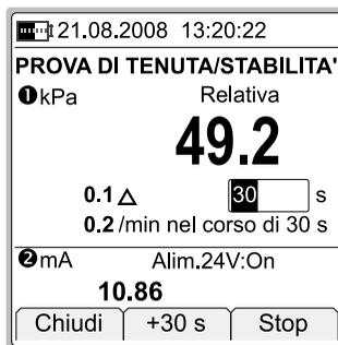
Per avviare la prova, verificare prima di tutto il tempo di prova da usare. Accettare il valore predefinito, oppure inserire un altro periodo di tempo in secondi. Inserendo zero come tempo della prova, si indica che la prova continuerà fino a quando non viene arrestata manualmente. Selezionare **F1/Avvio** e vedere come avanza la prova.
