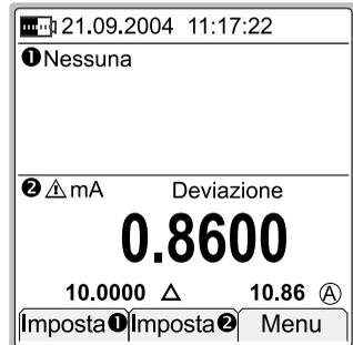
Quando la misurazione della deviazione è attiva, il testo **"Deviazione"** viene mostrato sul valore della deviazione.
