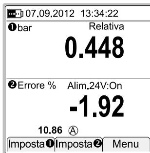
L'immagine precedente mostra un esempio in cui viene tarato un trasmettitore di pressione usando la modalità di visualizzazione dell'errore in percentuale della corrente in uscita. La linea informativa addizionale mostra la corrente in uscita attuale dello strumento. Un altro metodo utile, soprattutto durante la regolazione dello strumento, consiste nel visualizzare la barra grafica dell'errore nella linea informativa addizionale.
