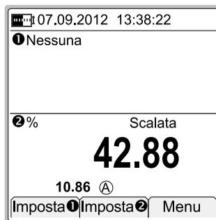
Quando la visualizzazione della percentuale è attiva, il simbolo "%" viene visualizzato dopo il triangolo di avvertimento e il testo **Scalato** viene mostrato sul valore in percentuale.
