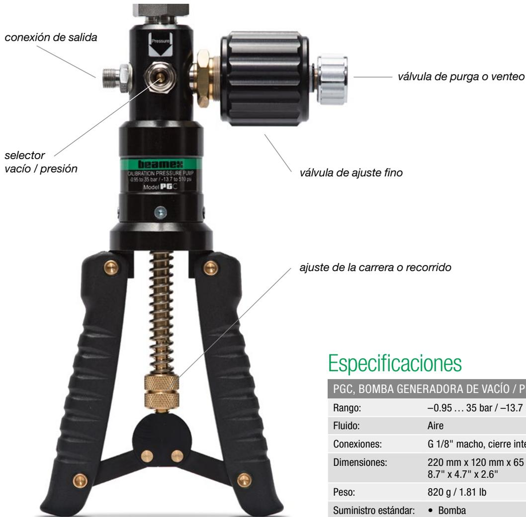
La **PGC** es una bomba de calibración manual que se puede utilizar para generar vacío y presión. Usando el selector de Vacío / Presión se puede cambiar rápidamente su funcionalidad pasando de una forma rápida a generar vacío o presión o viceversa. Con el ajuste fino se puede ajustar con precisión el valor de generación de vacío o presión deseado.
