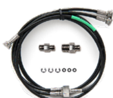
Tryckslangar 40 bar/600 psi tryck sats med T-slang 1,5 m (5 fot) med NPT-kopplingar och tätningar. Slangarna har Bx G1/8" hongänga i alla ändrar.
