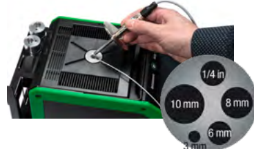
Insatser för MC6-T Utbytbara insatser med hål av olika storlek för att möjliggöra kalibrering av temperaturgivare med olika diameter.
