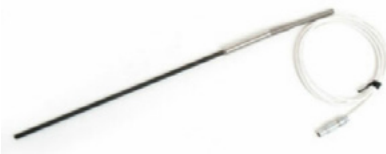
Beamex RPRT Referensgivare med hög noggrannhet. Temperaturområde upp till 660 °C (1 220 °F).
