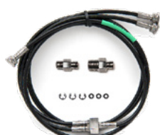
Flexibles Jeu de flexibles en T de pression 40 bar/600 psi d'une longueur de 1,5 m (5 pieds) avec raccords NPT et joints. Les flexibles ont des filetages femelles Bx G1/8" à toutes les extrémités.
