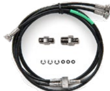
Paineletkut 40 bar paineen T-letkuserja 1,5 m NPT-liittimillä ja tiivisteillä. Letkuissa on Bx G1/8" naaraskierre molemmissa päissä.
