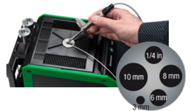
MC6-T:n sisäelementit Vaihdettavia sisäelementtejä, joissa on erikokoisia reikiä, jotta voidaan kalibroida halkaisijaltaan erikokoisia lämpötila-antureita.
