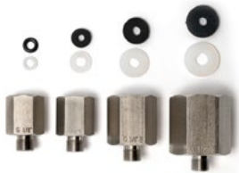
Paineliittimet Bx G1/8" uros (40 baarin letkuille), Bx 1215 uros (630 baarin letkuille), paineliittinsarjat ja putkiliittimet.
