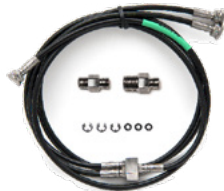
Tubos flexibles/mangueras de presión Juego de tubos flexibles de presión en T de 40 bar / 600 psi de 1,5 m (5 pies) con adaptadores con roscas NPT. Los tubos tienen roscas hembra Bx G1/8" en todos los extremos.
