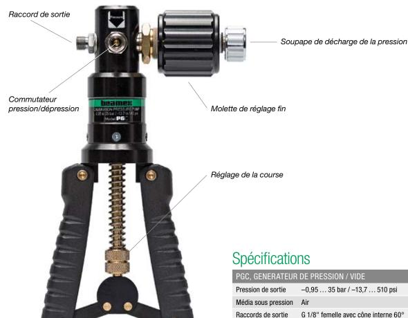
**La PGC** est une pompe à main pneumatique destinée à générer de la pression et du vide. Grâce au commutateur vous pouvez rapidement choisir entre génération de pression ou de vide. Le réglage fin permet d'ajuster précisément la pression générée.
