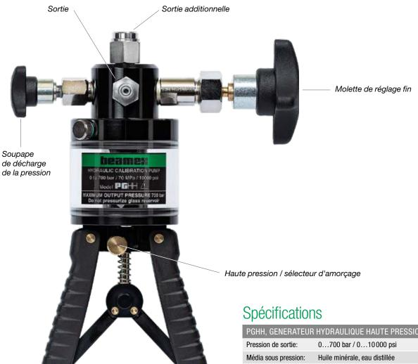
La PGHH est un générateur de haute pression hydraulique portable compatible avec de nombreux liquides différents (ex. l'huile minérale, l'eau distillée, etc.). La pompe est équipée d'une commande de volume ajustable qui permet le réglage fin de la pression générée. La PGHH peut être équipée d'une soupape de sécurité en option permettant une protection réglable contre les surpressions dans différentes plages.
