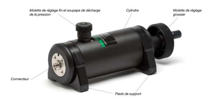
**La PGL** est une pompe d'étalonnage qui sert à générer une pression de référence précise et stable pour les étalonnages de basse pression sur une plage de ±400 mbar (±160 iwc). Le design innovant et le choix des matériaux minimisent l'impact des changements de température de l'environnement pendant l'étalonnage. La pression peut être ajustée par un réglage grossier et fin à vis.
