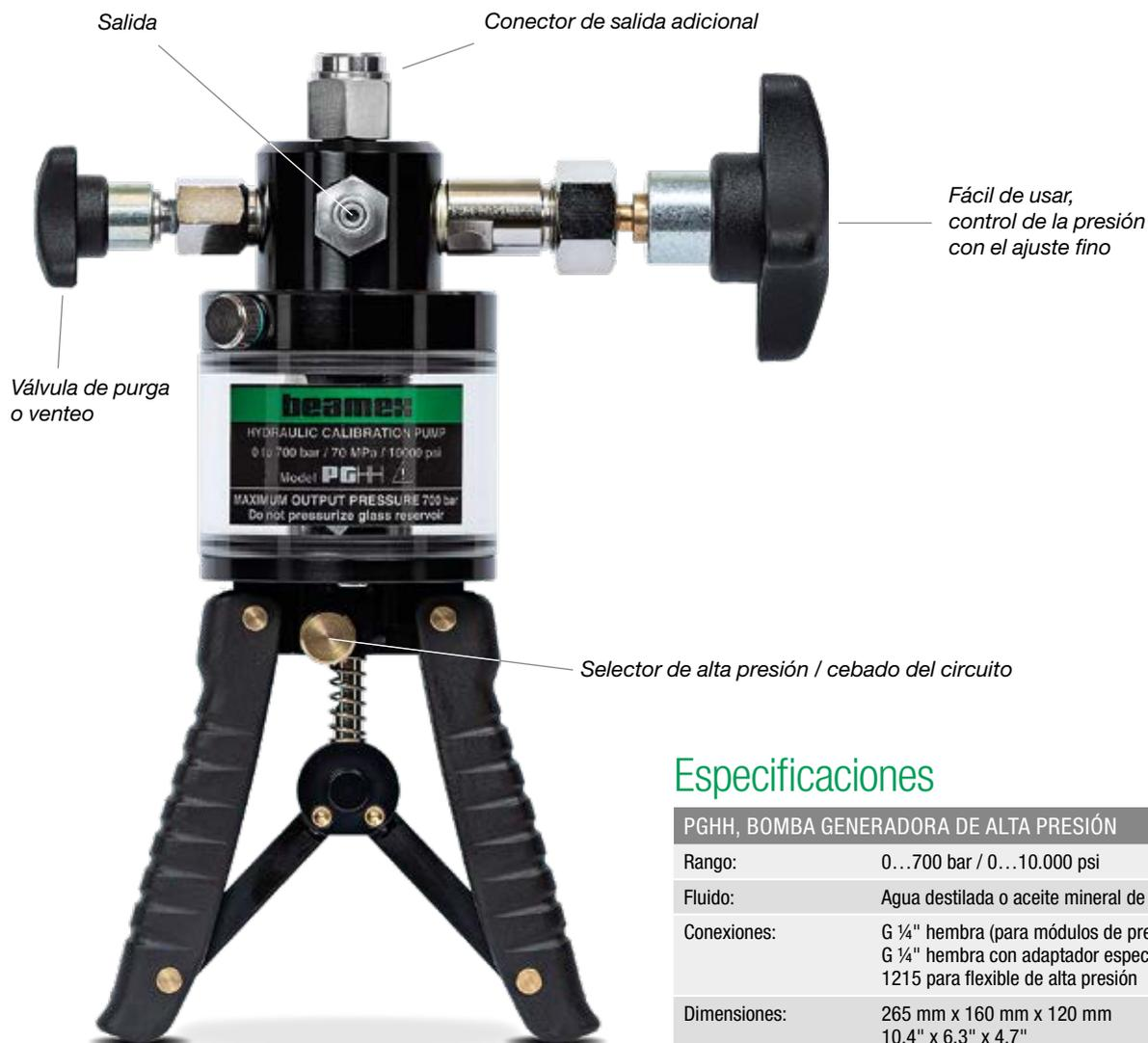
La **PGHH** es una bomba hidráulica generadora de alta presión, portátil y compatible con muchos tipos de fluidos (aceite mineral, agua destilada, etc.). La bomba cuenta con un control de volumen que permite ajustar con facilidad y gran exactitud la presión deseada. La PGHH dispone de un selector de alta presión que permite un fácil y rápido cebado del circuito.
