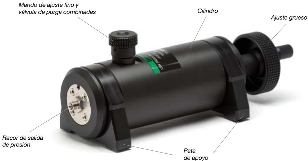
La bomba de calibración **PGL** puede utilizarse para generar una presión de referencia precisa y estable para calibraciones de baja presión en un rango de  $\pm 400$  mbar ( $\pm 160$  iwc). El innovador diseño y la óptima selección de materiales minimizan el impacto de los cambios de temperatura ambiental durante la calibración. La presión se puede ajustar mediante mandos de ajuste grueso y fino.
