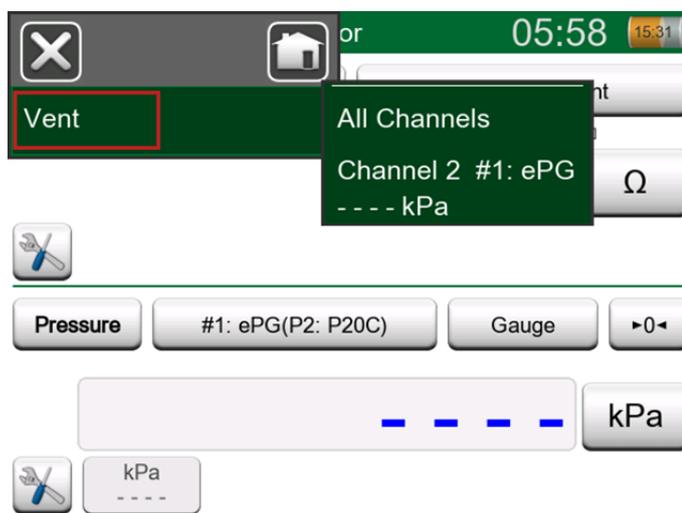
**Abbildung 17: Entlüftungsmenü – Kalibratormodus**
