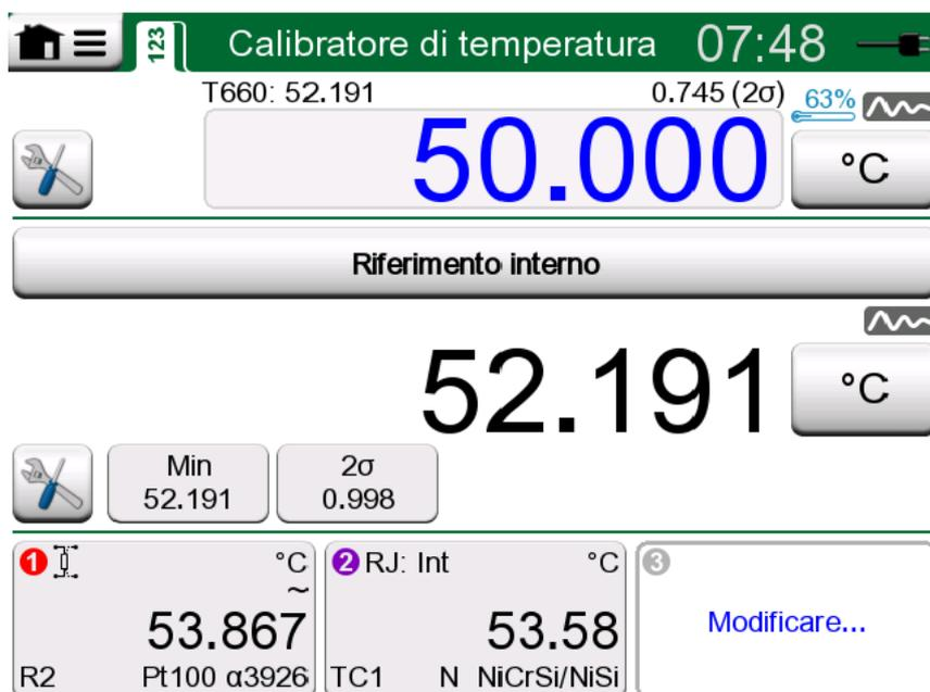
**Figura 51: Schermata principale calibratore di temperatura**
