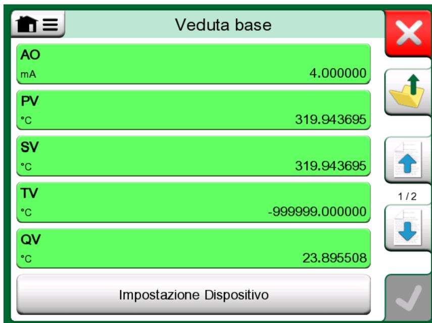
**Figura 131: Esempio schermata di base HART**
