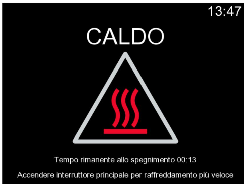
**Figura 6: Modalità avviso temperatura**
