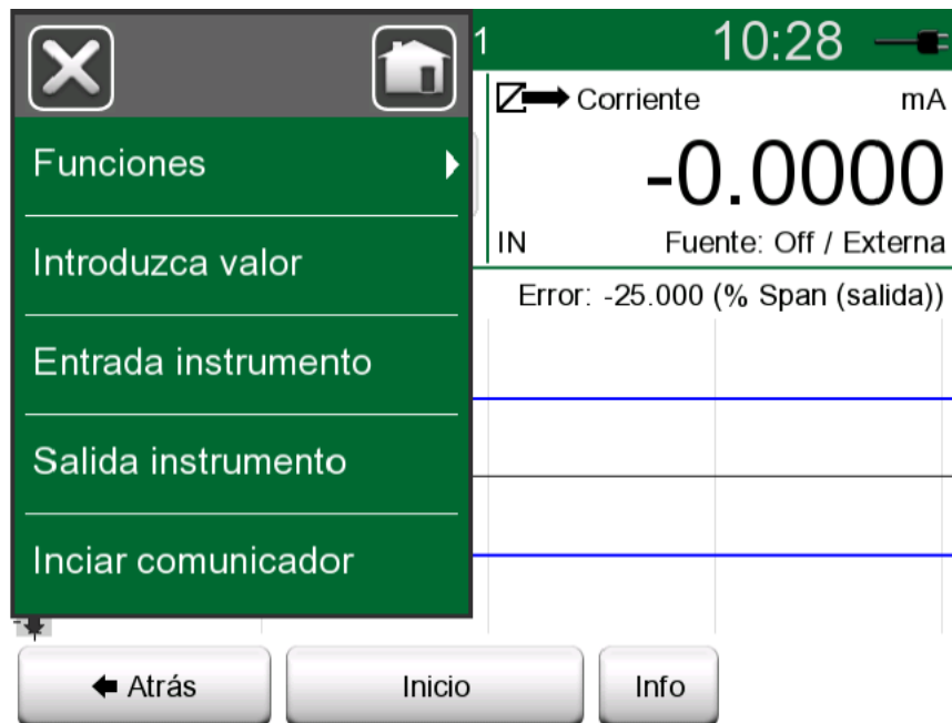
Figura 90: Menú del Calibrador Documentador durante la calibración de un instrumento HART
