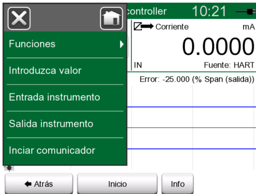
Figura 122: Menú Calibrador Documentador con instrumento HART conectado
