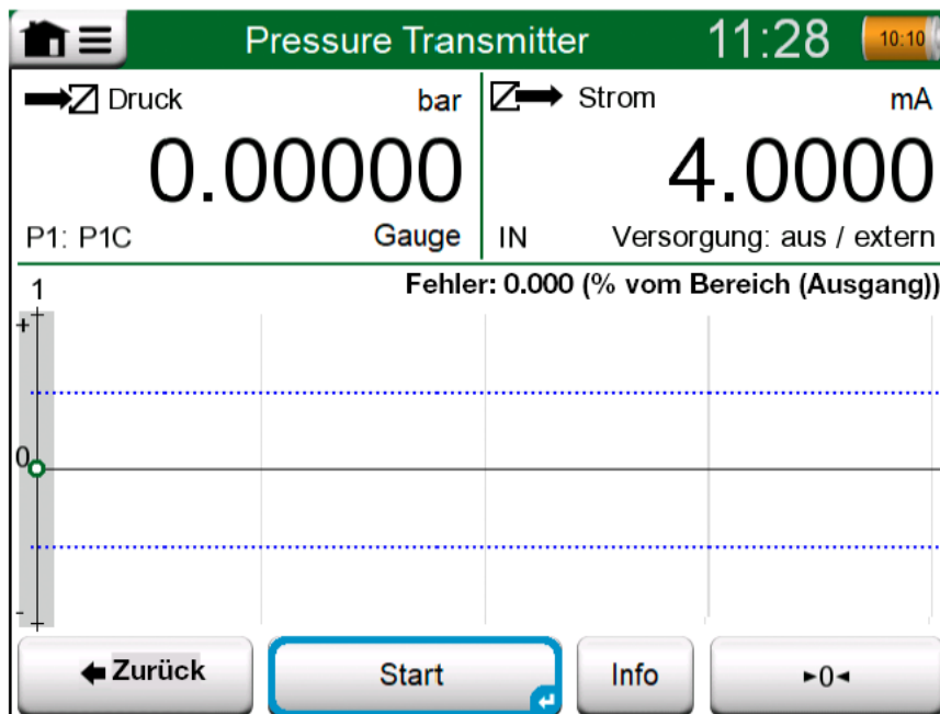
Abbildung 83: Taste für die Nullstellung eines Druckmoduls (rechte untere Ecke)
