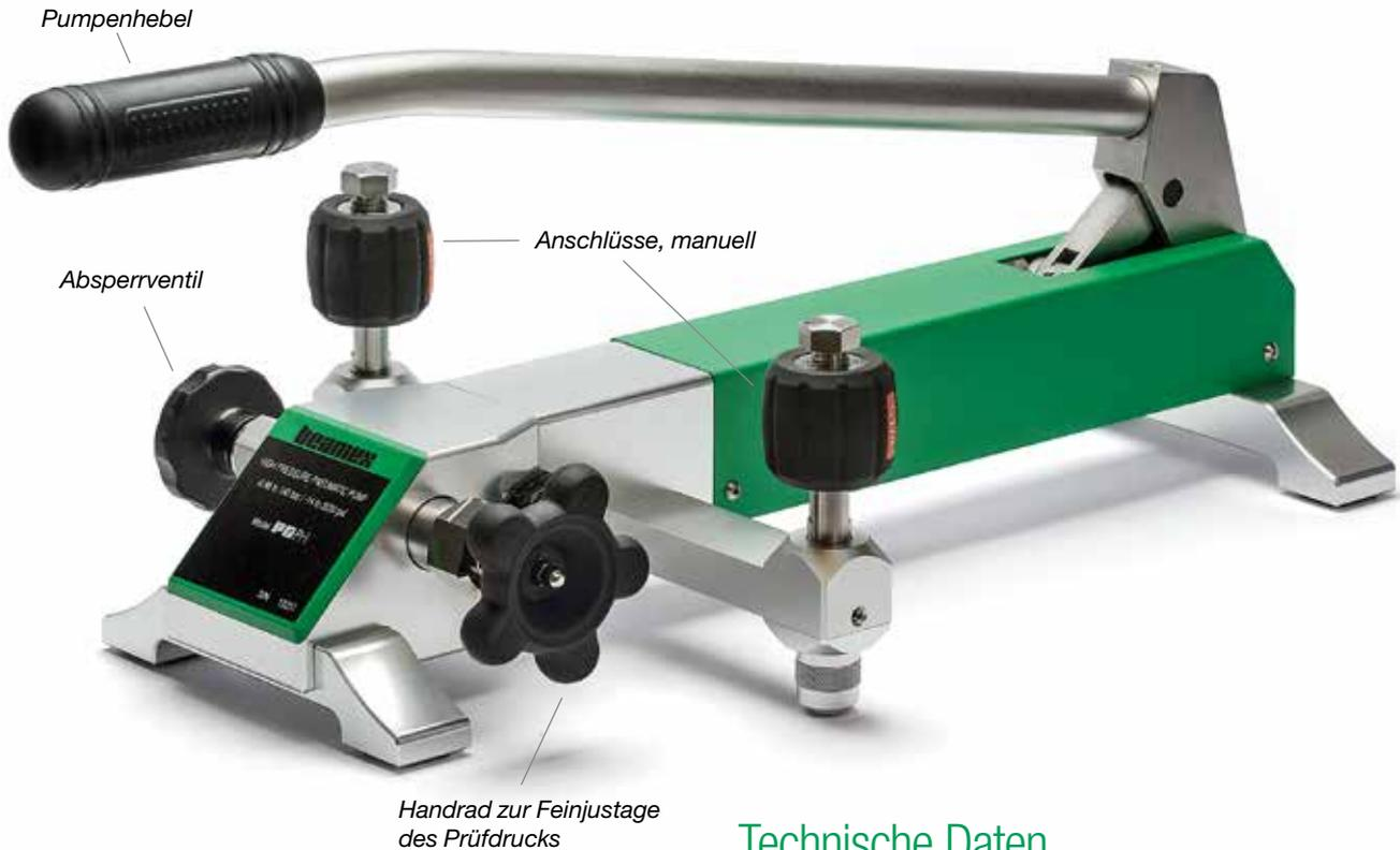
Die Beamex **PGPH** ist eine pneumatische, mit Umgebungsluft arbeitende, Hochdruckpumpe zur effizienten Erzeugung von Druck und Unterdruck. Schnell und ohne Mühe – Sie benötigen weniger als eine Minute um den Maximaldruck zu erzeugen. Das in der PGPH verwendete Variovolumen bietet eine sensible Feinregulierung des gewünschten Druckwertes, der an zwei Druckanschlüssen zur Verfügung steht.
