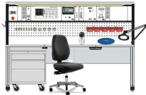
**Système protégé contre les décharges électrostatiques pour la manipulation de circuits imprimés et de composants électroniques**
