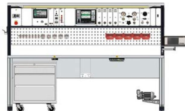
**Système pour un étalonnage de pression extrêmement précis allant du vide à 1000 bars.**
