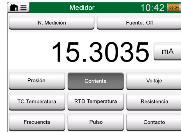
Medición de corriente utilizando el Medidor
