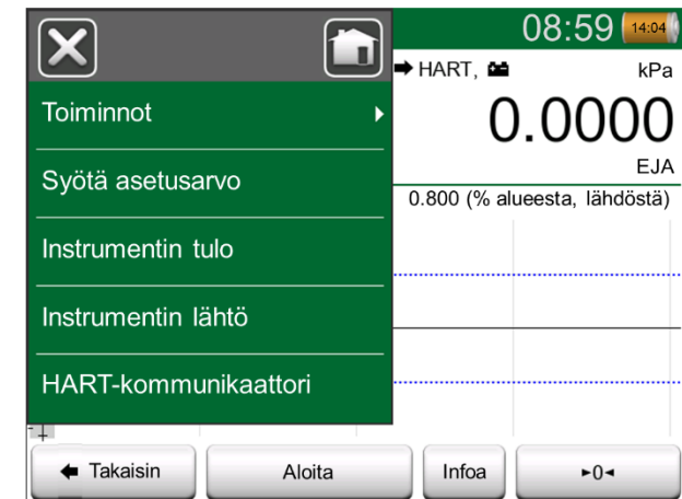
Dokumentoivan kalibraattorin valikko, kun kalibroidaan HART-instrumenttia.
