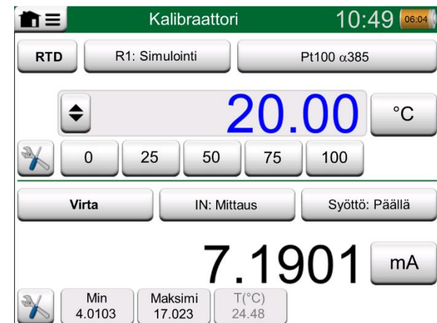
Kalibraattori käytössä. Ylemmässä apuikkunassa RTD-anturin simulointi ja alemmassa virran mittaus.
