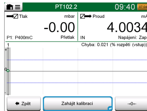
Tlačítko pro nulování tlakového modulu se nachází v pravém spodním rohu okna.
