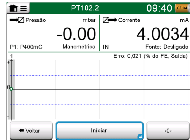
Botão para zerar um módulo de pressão no canto inferior direito.
