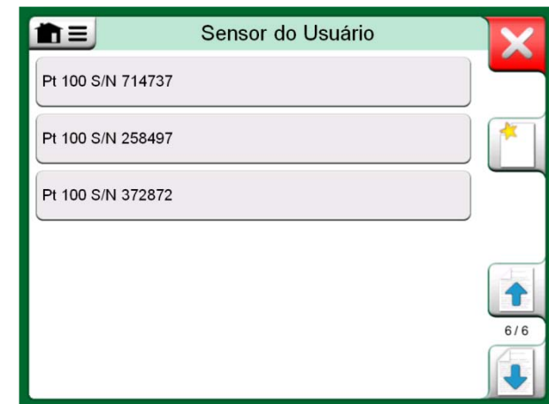
Um exemplo de uma lista de sensores PRT customizados digitados no MC6.
