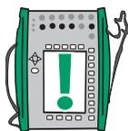
Si la résistance du circuit externe dans la simulation de thermocouple est très basse (court circuit évident), le message «**O.CHARGE**» est affiché jusqu'à ce que la charge soit acceptable.
