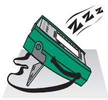
Mit der ausklappbaren Stütze lässt sich der MC5-iS mit einem guten Sichtwinkel auf einer Tischoberfläche aufstellen.
