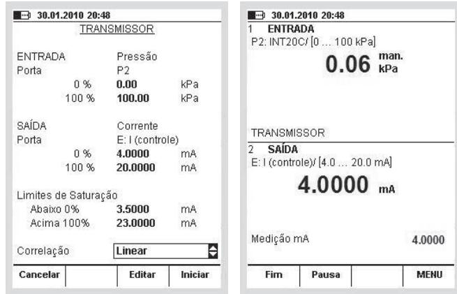
Insira os spans de entrada e saída, os limites de saturação e também a função de transferência.
