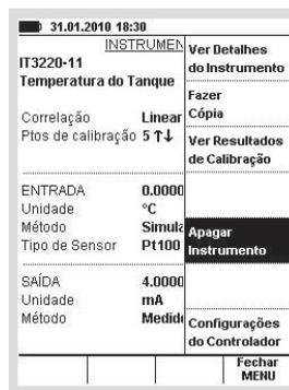
Para remover um único instrumento (e suas calibrações), selecione na lista ID Posição. Quando visualizar a janela do instrumento, pressione **D/MENU** e **5/Apagar Instrumento** (veja a figura da direita acima).
