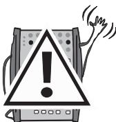
Se você der curto na saída da simulação de termo-elemento, MC5-IS tenta manter a tensão aumentando a corrente de saída. Se você então abrir a saída novamente, a tensão é primeiramente muito alta, e então retorna para o nível correto. Como este pico de tensão pode danificar os componentes do circuito, certifique-se que o circuito pode ser encurtado ou protegido contra tensões superiores. Pela mesma razão, sempre insira saída de 0°C antes de conectar o circuito.
