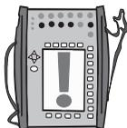
Se o valor medido de resistência for infinito ou muito alto (> 4000 ohm), o texto **+OVER** é mostrado na janela de medição. Isso significa que o circuito está quebrado ou que a conexão está errada. Conexão errada pode também resultar em erros de leitura, tipicamente para baixo. Se necessário, use a medição do 2 fios ohm para verificar o cabeamento antes da conexão final.
